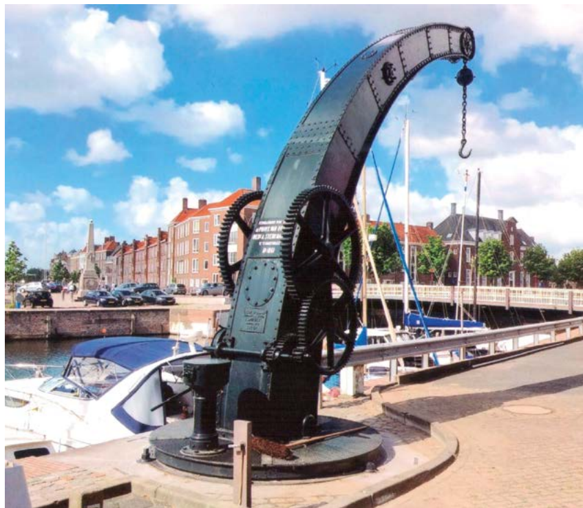
De enige andere kadekraan van hetzelfde Fairbairn-ontwerp in Nederland staat in Middelburg op de Rotterdamsekaai. Het rijksmonument is evenwel vastgezet. De replica in Kampen kan als alles meezit gebruikt worden. (foto: Jan Elhorst)
